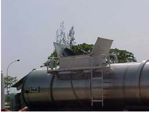
Foto 13 - Tampa de Visita Aberta
